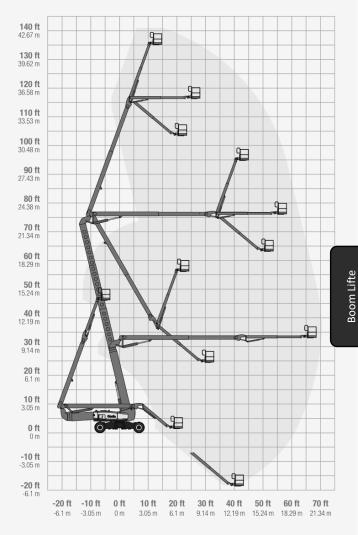
Reichweite unter Nullniveau 5,87 m Übergreifende Höhe bei 23,01 m
